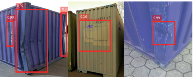
Das COOKIE-System erkennt Dellen bei Schiffscontainern
