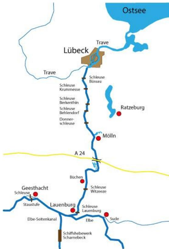
Abbildung 3.3: Schematische Darstellung des ELK mit den Schleusen [25]
